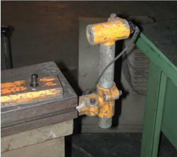
Fig. 36 – Fotocellula monoraggio ruotata in avanti
