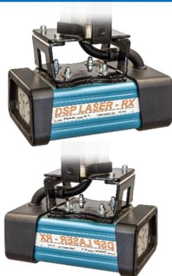
Il DSP **emette una barriera laser visibile** che, realizzata e posta come descritto nella norma EN12622, **protegge l'operatore** della pressa piegatrice contro il pericolo di essere schiacciato tra la parte superiore e quella inferiore durante la chiusura della piega in alta velocità.
