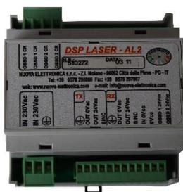
Il Modulo AL2 è un modulo elettronico la cui logica è stata pianificata **per monitorare e gestire i sistemi e i componenti presenti su una pressa piegatrice** per garantire la sicurezza del processo di piegatura stesso in base a quanto previsto dalla norma EN12622.
