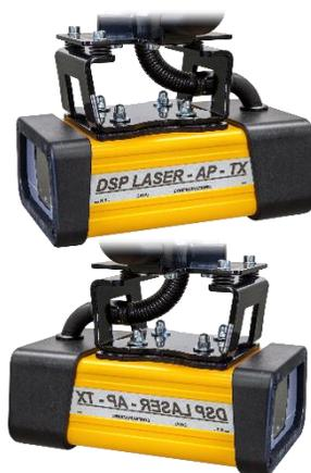
Il DSP AP **emette una barriera laser visibile** che, realizzata e posta come descritto nella norma EN12622, **protegge l'operatore** della pressa piegatrice contro il pericolo di essere schiacciato tra la parte superiore e quella inferiore durante la chiusura della piega in alta velocità.
