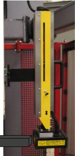
*Sistema per la verifica dello spazio di arresto*
