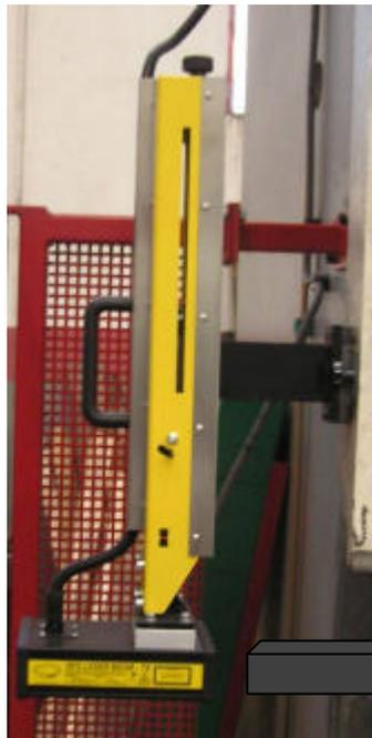
*Il trasmettitore produce un fascio che nello spazio è rappresentabile come un parallelepipedo*
