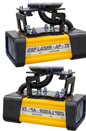
Il DSP AP **emette una barriera laser visibile** che, realizzata e posta come descritto nella norma EN12622, **protegge l'operatore** della pressa piegatrice contro il pericolo di essere schiacciato tra la parte superiore e quella inferiore durante la chiusura della piega in alta velocità.
